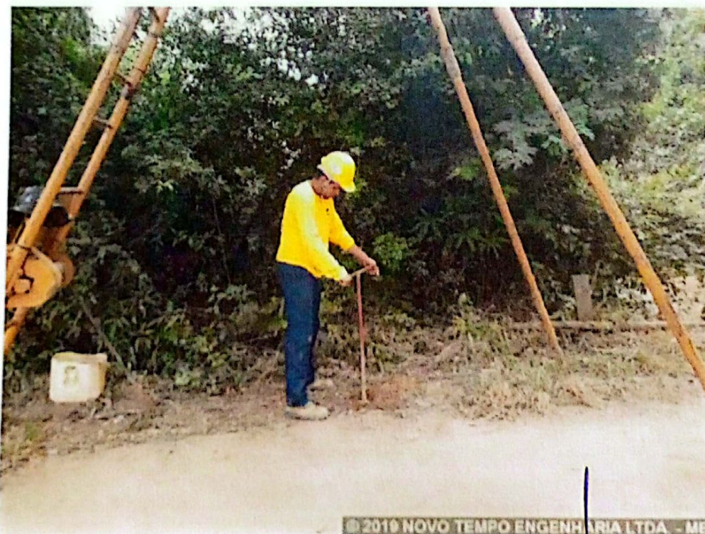
EXECUÇÃO SONDAGEM A PERCUSSÃO SP 02 – FAZENDA LAGOA/MG
